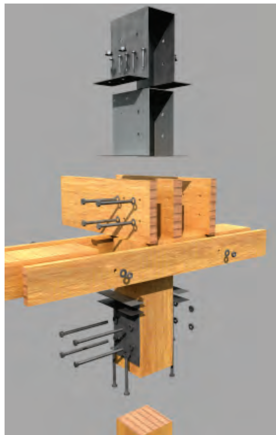
Esploso assometrico del sistema di aggancio trave-pilastro
