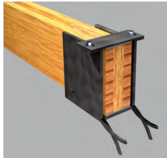
Sistema di aggancio delle travi al muro
